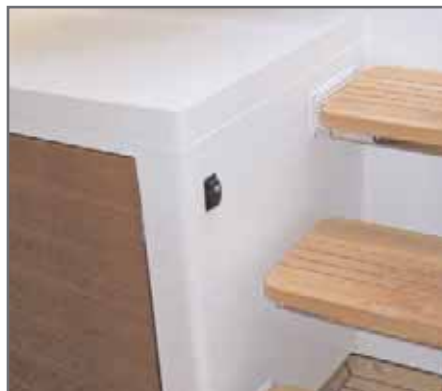
INTERRUTTORE (POZZETTO) DI APERTURA DEL PANNELLO DI ACCESSO AL FLY
