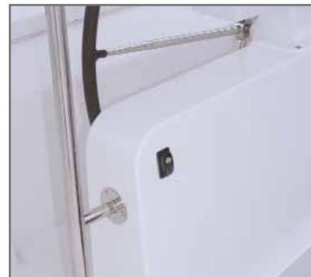
INTERRUTTORE (FLY) DI APERTURA DEL PANNELLO DI ACCESSO AL FLY
