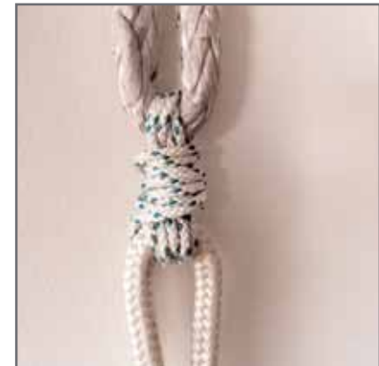
SURLIURE ENTRE LA DRISSE ET SON EXTENSION
