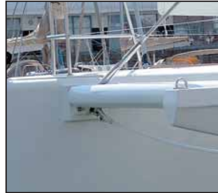
FIXATION DE LA PANTOIRE A LA POUTRE AVANT
