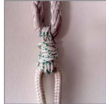
La falcaceadura tiene que soportar la tensión necesaria para izar la vela.
