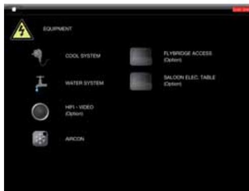
Accesso ai menu attrezzature (consente di mettere sotto tensione o fuori tensione le diverse attrezzature della barca)
